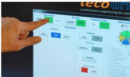
*Die Bedienoberfläche flexcontrol des Vorschubes. Das Vor- und Zurückschieben des Bandes mittels Tippen im begrenzten Bereich einer Vorschublänge ermöglicht ein einfacheres Anstanzen.*
